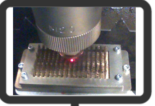
Lavorazione programma con visualizzazione percorso utensile. Program processing with tool path display.
